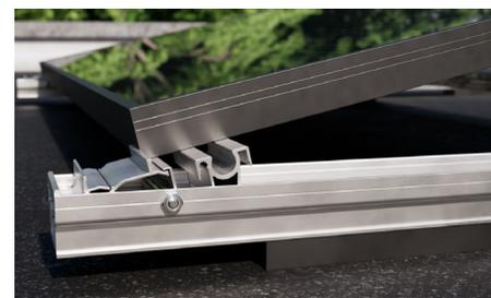
Los paneles con una anchura entre **1035 mm y 1070 mm** se deben colocar apoyados en el perfil de aluminio inferior, lo que alejará el borde de plástico. Hay disponible un pieza especial para paneles con una anchura de entre **1071 mm y 1150 mm**.
